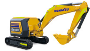
リチウムイオンバッテリー搭載のフル電動・オペレーター非搭載式ミニショベルのコンセプトマシン
