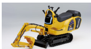
Honda Mobile Power Pack搭載の電動マイクロショベルPC01(試作車)
