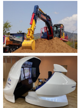
遠隔操作仕様油圧ショベル(上)と遠隔操作作用コックピット(下)
