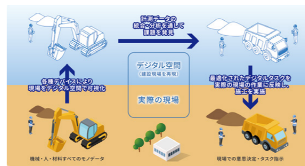
「DXスマートコンストラクション」による“デジタルツイン”施工
