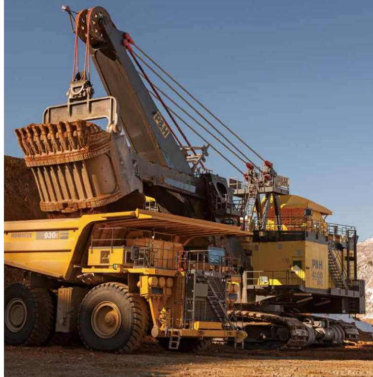
チリの鉱山で稼働する“P&H”ロープショベルとコマツ「930E」ダンプトラック (“P&H”はコマツマイニング(株)のブランドです)
