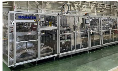
コマツNTCの車載電池製造装置
