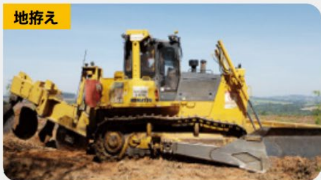
地拵え用機械 D85EX サブソイラー
