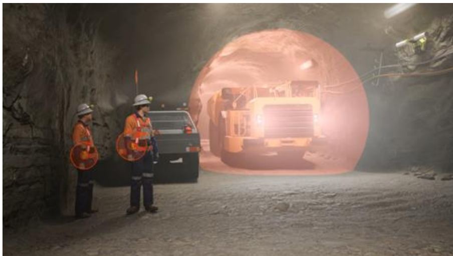
坑内掘り鉱山向けの高速・低遅延デジタル通信システム と坑内測位・近接検知ソリューション
