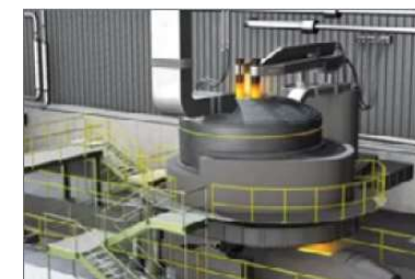
超断熱を実現する 次世代溶解炉のイメージ
