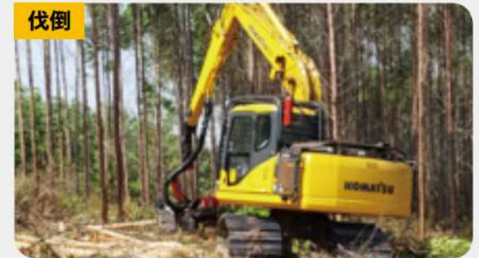
伐倒 油圧ショベルベースの林業機械 PC130F ハーベスター仕様
