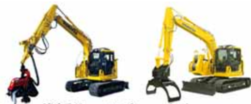
伐採ハーベスタ 木寄せスイングヤード
