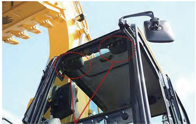
ステレオカメラ(運転室内上端)を搭載したPC200i
