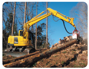
PC138US 格納ブラケットハーベスタ Harvester processor with storable bracket specification
