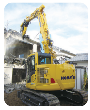
PC138US 解体2ピースブーム Demolition 2 piece boom specification
