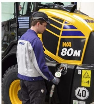
工場充填燃料をディーゼル燃料から水素化植物油（HVO燃料\*）に切り替え（欧州）
