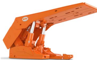
ルーフサポート ソフトロック採掘時の崩落を防止
