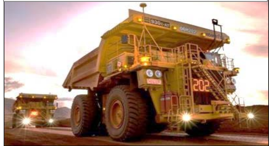
無人ダンプトラック運行システム Autonomous Haulage System(AHS)
